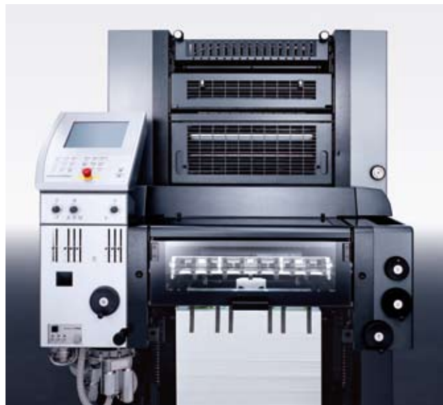
Der kompakte Normalstapelausleger zeichnet sich durch geringen Platzbedarf aus.
