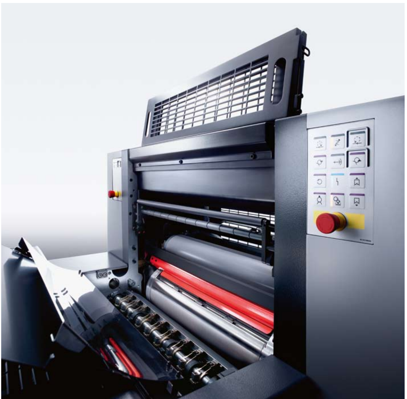
Das Kammrakovelsystem sorgt für beste Lackierergebnisse.
