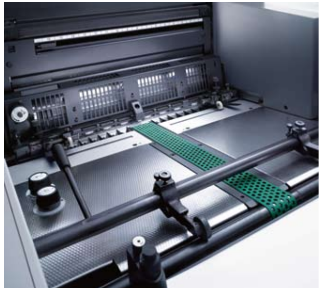
Der Anleger mit zentralem Saugband sorgt für einen markierungsfreien Bogentransport.
